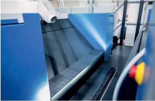
Die Rapida 106 ist unter anderem mit Inline-Farbreglung QualiTronic ColorControl ausgerüstet.
