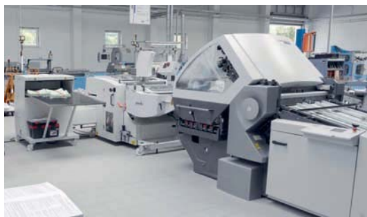
Die palamides-Auslage wird flexibel sowohl an der Falzmaschine als auch am Sammelhefter eingesetzt.
