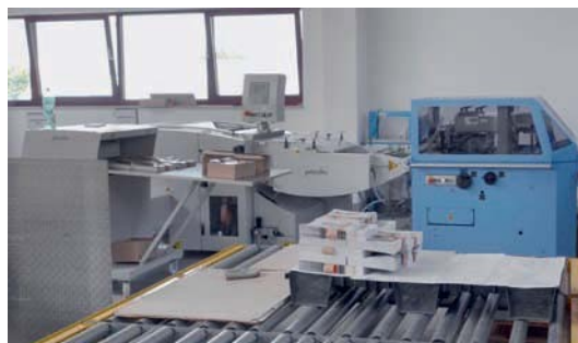
Die palamides-Auslage wird flexibel sowohl an der Falzmaschine als auch am Sammelhefter eingesetzt.
